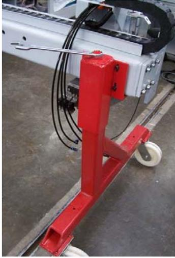
调整横梁小车上的螺丝，安装横梁固定螺丝和定位销
