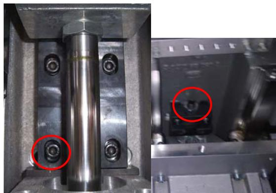
夹钳的固定螺丝和高度调节螺丝
