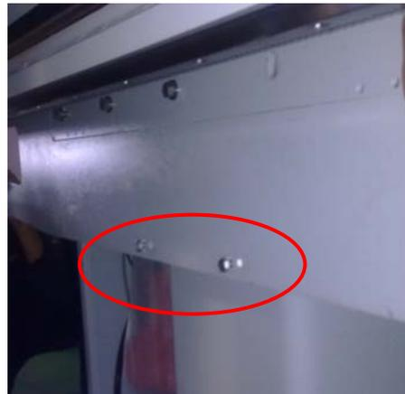
两个螺丝（母）穿入并固定在主机上，用于在穿定位销时，使横梁和主机的接触面相互平行
