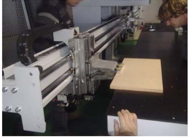
夹钳夹紧工件沿 X 轴移动工件到进料台面上方调整进料台面的高低
