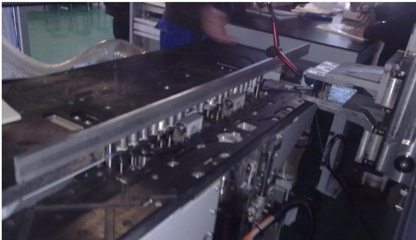
百分表针打在两个伸出钻轴支起的直尺上，检查钻盒垂直方向是否与 X 轴平行
