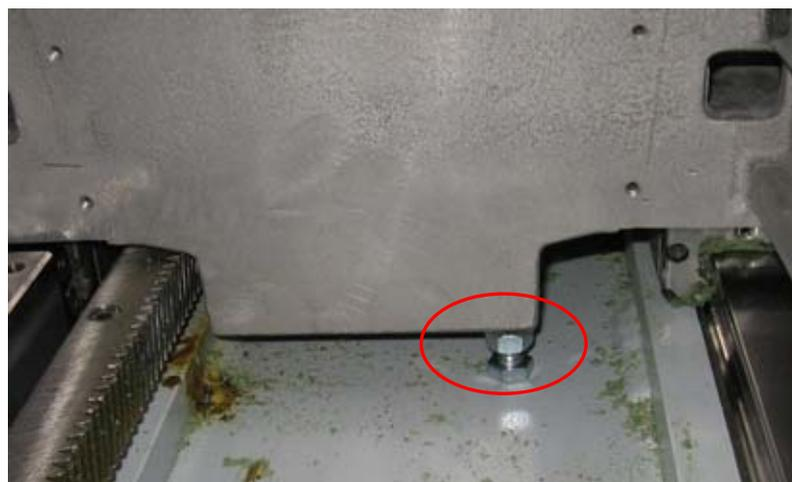
下装置在拆滑块时先安装螺丝将装置顶起，可以移动滑块
