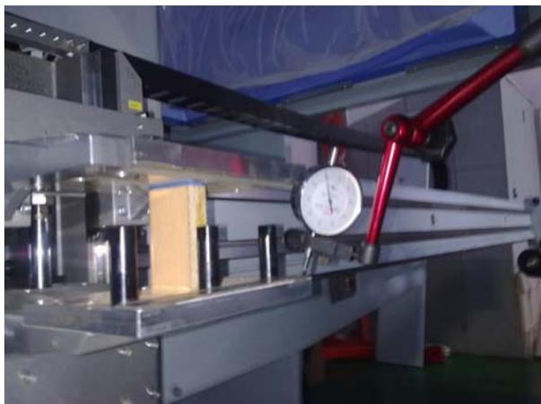
磁座固定在上机头，测量夹钳的高度和 X 方向的水平度
