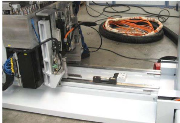
主机就位拆除紧固件后，去除导轨防护罩，调节设备 X 和 Y 方向水平
