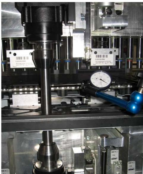
上下铣刀轴的校准：在同一坐标位置里测试棒可以用手上下插入上下刀卡里，百分表校正垂直度
